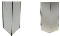
**Ein kurzer Tipp:** Je schärfer die Spitze auf dem Rad, desto aggressiver der äußere Seitenplattenwinkel. Ein weniger steiler Winkel führt zu einer weniger aggressiven Seitenplatte. Beachten Sie, wie sich die Radform auf die Seitenplattenwinkel in den folgenden Bildern auswirkt.
